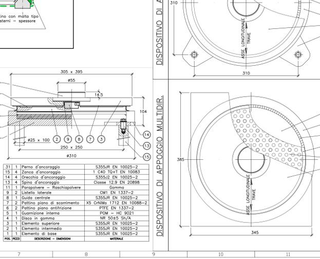
CARPENTERIA COLLEGAMENTO APPOGGIO FISSO E UNIDIR. - TRAVE (Blocco1)
